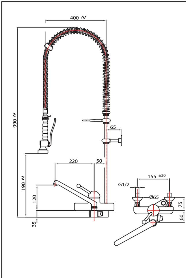
**Wand-MIX-Einhebelmischer mit kurzem Griff,
